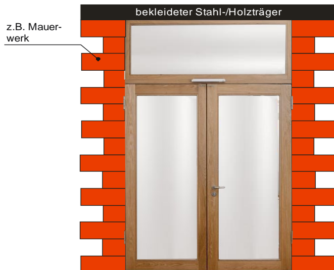
Abbildung 5: Anschluss an einen statisch erforderlichen (bekleideten) Stahl-/Holzträger
